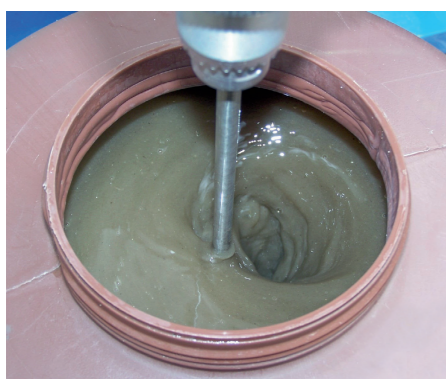
Bild 6 Phosphorinkorporation eines Belebtschlamm-Abwasser-Gemischs
