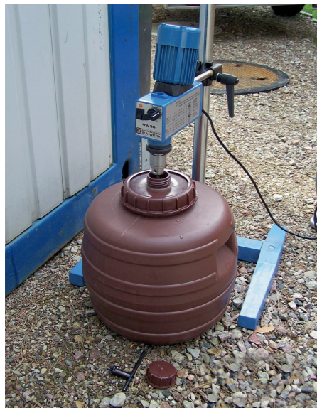
Bild 5 Versuchsanordnung zur messtechnischen Erfassung der Phosphorrücklösung
